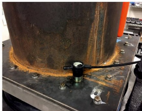
▲ Рис. 2. Высокочувствительный геофон и заглубляемый регистратор NRU в стальном цилиндре с уплотненным грунтом (слева). Контрольный геофон был приклеен (справа) к вибростолу, к которому жестко крепился стальной цилиндр.
