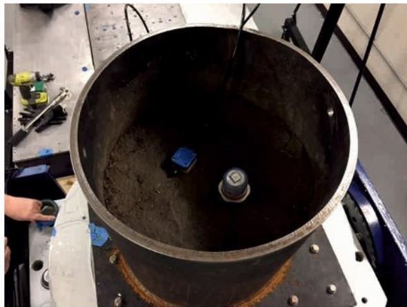
▲ Рис. 2. Высокочувствительный геофон и заглубляемый регистратор NRU в стальном цилиндре с уплотненным грунтом (слева). Контрольный геофон был приклеен (справа) к вибростолу, к которому жестко крепился стальной цилиндр.
