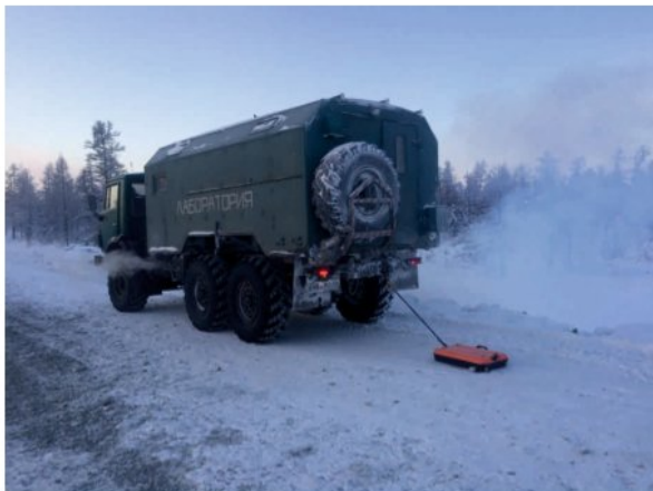
▲ Рис. 3. Технология георадарного профилирования при обследовании подъездной автодороги.
