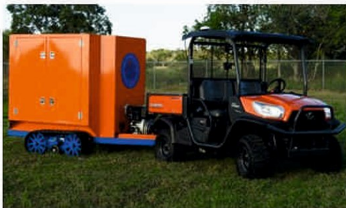
▲ Рис. 5. Автоматизированные прицепы на колесном или гусеничном ходу, несущие до 300 регистраторов NRU, вдавливаемых в грунт по команде оператора в специально подготовленные лунки.
