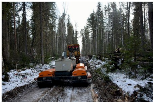
▲ Рис. 2. Спарка источников «Енисей-СЭМ-100», технология Glide.
