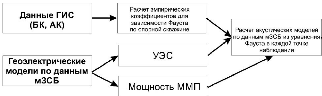
▲ Рис. 3. Принципиальная схема расчета скоростной модели ВЧР на основе данных мЗСБ через эмпирические зависимости Фауста.
