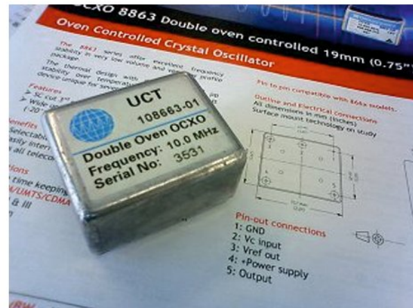
▲ Рис. 4. Термостатированный кварцевый осциллятор с двойной печкой.
