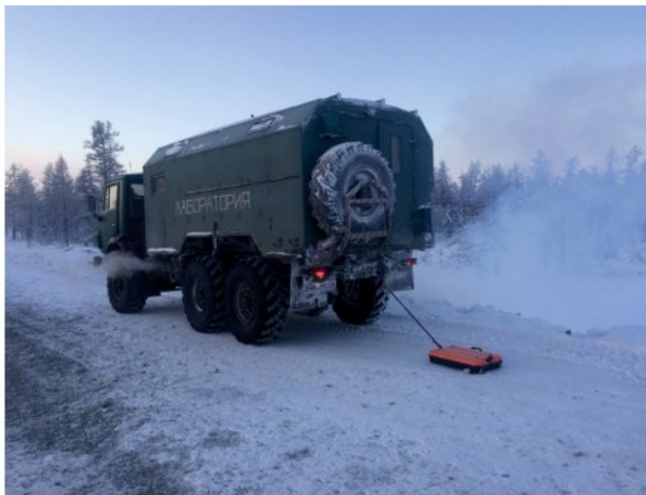
▲ Рис. 3. Технология георадарного профилирования при обследовании подъездной автодороги.
