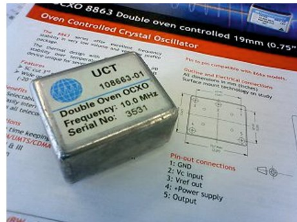
▲ Рис. 4. Термостатированный кварцевый осциллятор с двойной печкой.
