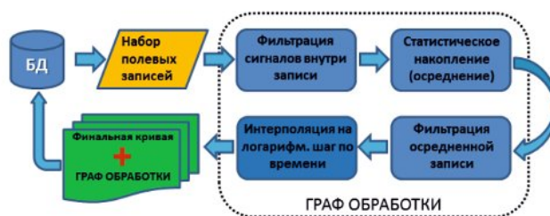
▲ Рис. 3. Конвейер обработки данных в программе TEM-Processing.
