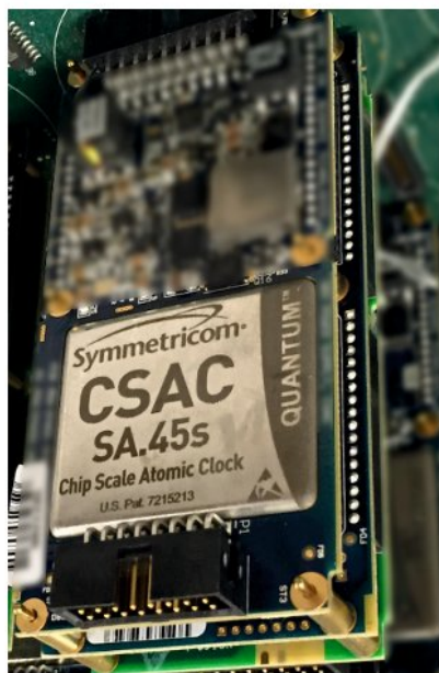
▲ Рис. 5. Чип цезиевых атомных часов.
