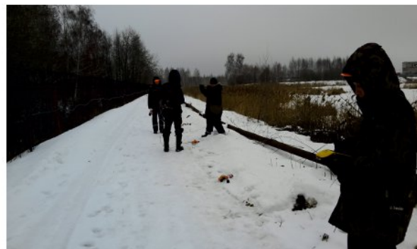
▲ Рис. 5. Фото 4 Технология сейсмозондирования МПВ на дамбе хранилища промстоков.
