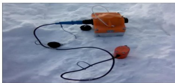
▲ Рис. 1в. Вариант расстановки блока БАР-3.1 на профиле с одиночным геофоном.
