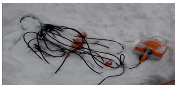
▲ Рис. 1б. Вариант расстановки блока БАР-3.1 на профиле с группой геофонов.
