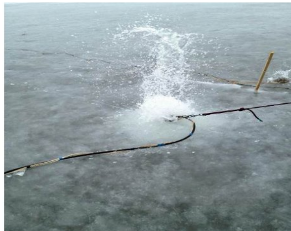
▲ Рис. 11. Возбуждение сейсмического сигнала одиночным пневмоисточником «Малыш».
