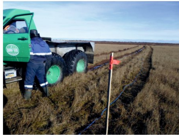
▲ Рис. 4. Раскладка телеметрических кос с применением специализированной малогабаритной техники на колесах низкого давления (вездеход Литвина)
