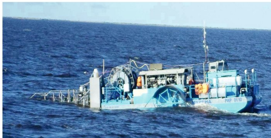
▶ Рис. 2. Универсальное судно-раскладчик/источник «Мурена».
