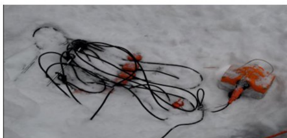
▲ Рис. 1б. Вариант расстановки блока БАР-3.1 на профиле с группой геофонов.
