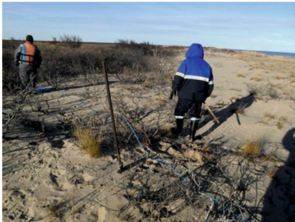
▲ Рис. 3. Раскладка телеметрических кос вручную.
