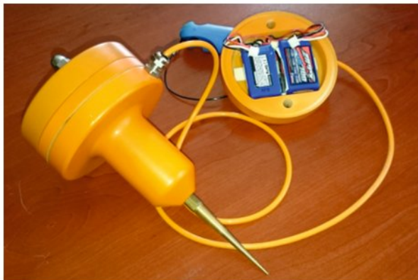
▲ Рис. 3. Экспериментальный образец геофона.
