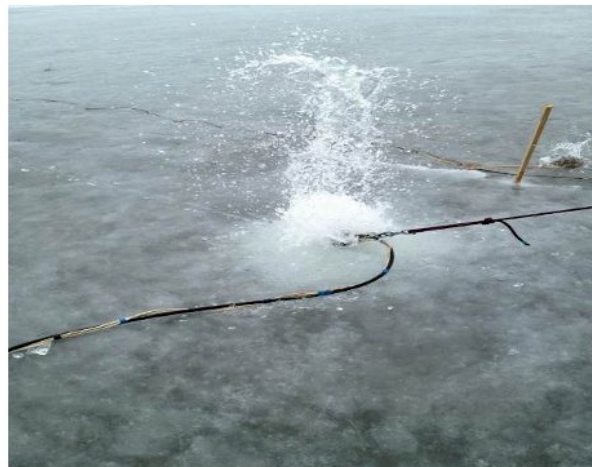
▲ Рис. 11. Возбуждение сейсмического сигнала одиночным пневмоисточником «Малыш».
