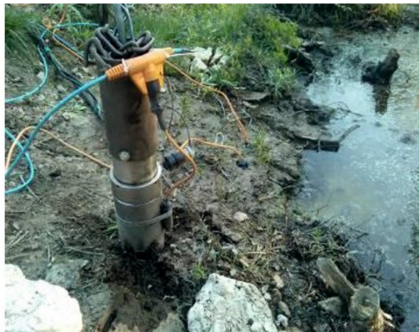
▲ Рис. 11. Возбуждение сейсмического сигнала одиночным пневмоисточником «Малыш».
