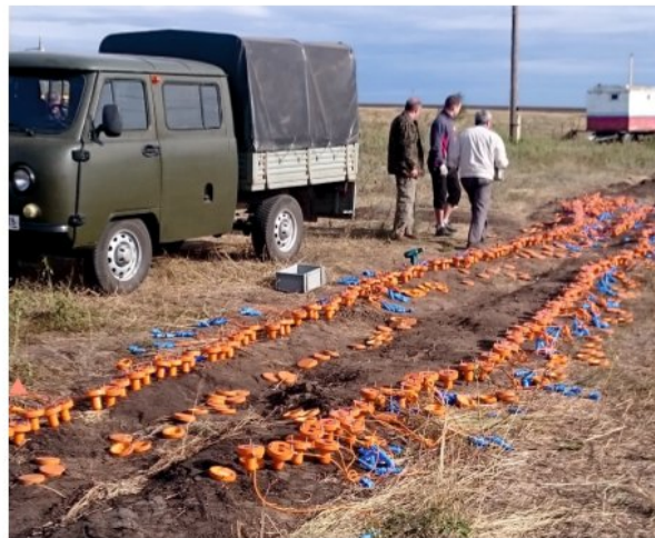
▲ Рис. 5. Проверка идентичности экспериментальных датчиков.
