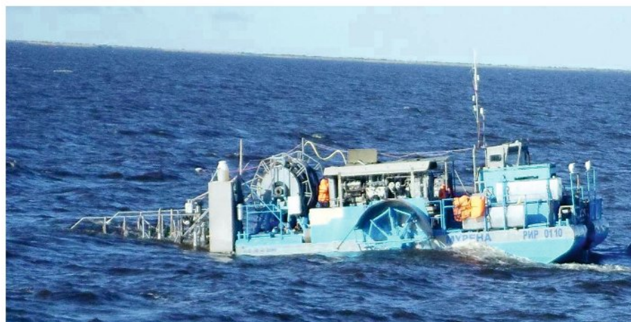
▶ Рис. 2. Универсальное судно раскладчик/источник «Мурена».
