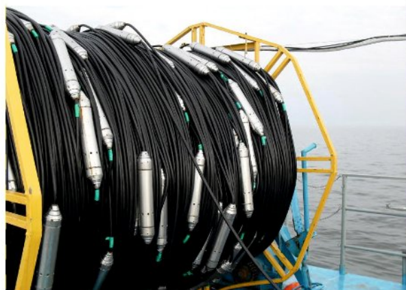
▲ Рис. 2. Телеметрический кабель и модули системы «XZone Marsh Line».
