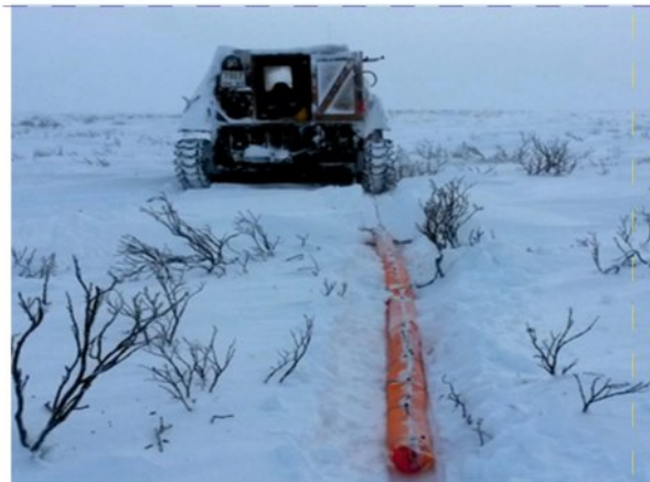
▲ Рис. 4. Процесс георадарной съемки с антенной «Тритон» АБДЛ 100.
