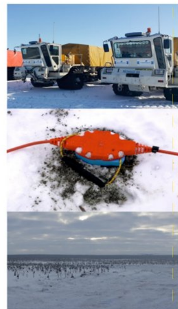
▲ Рис. 2. Схема опытных работ: параметры свипа (вверху слева), геометрия расстановки (внизу слева), источники (вверху справа), цифровые акселерометры DSU-428 (в середине справа) и фото с места опытных работ (внизу справа).
