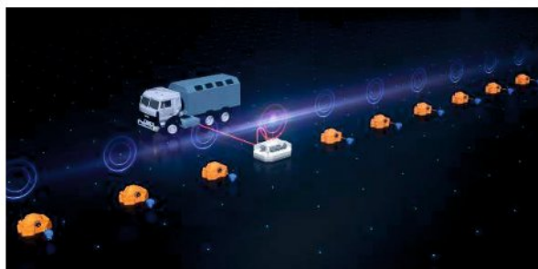
▲ Рис. 4. Принцип организации передачи информации в линии. Каждая часть линии передает информацию в коммутатор, который затем передает ее в управляющий компьютер через кабель.
