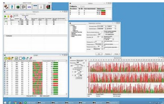
▲ Рис. 5. Внешний вид экрана управляющего компьютера. В левом нижнем углу отображаются все параметры каждого полевого модуля. В правом нижнем углу смоделирована ситуация с высоким уровнем микросейсмов при 3D расстановке. Обновление информации производится в реальном времени через беспроводную систему передачи данных.
