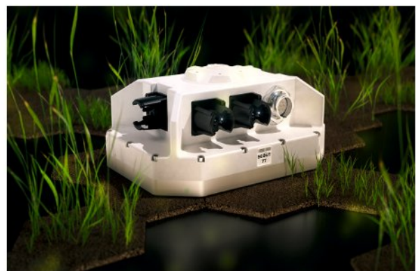
▲ Рис. 6. Внешний вид коммутатора линии. Коммутатор обеспечивает прием, обработку и передачу информации с БАР каждой линии в управляющий компьютер.
