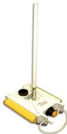
▲ Рис. 1. На внешней части корпуса WRU расположены: антенна повышенной прочности диапазона 2,4 ГГц; стандартный разъем геофона; антенна GPS; статусные индикаторы и две аккумуляторные батареи (по одной с каждой стороны).
