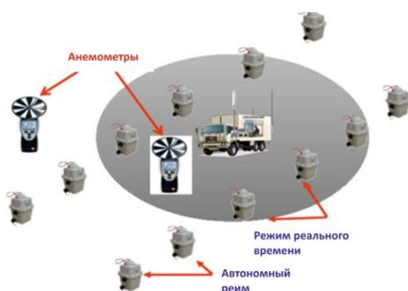
▲ Рис. 2. Режим «полуслепой» сейсмики 3D. Ближние каналы передаются в реальном времени по Wi-Fi благодаря антенне на сейсмостанции. Дальние каналы регистрируют данные автономно, и они считываются периодически с помощью передвижных антенн.
