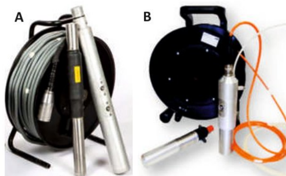
▲ Рис. 4. Оборудование для параллельного МСП (производитель «SOLGEO» Srl): А – высоковольтная кабельная линия с комплектом скважинных излучателей Р и SV волн «SPARKER» и «GEOS-H» соответственно; В – комплект сменных скважинных приемников с кабельной линией: прижимной трехкомпонентный геофонный зонд ATG-14 и гидрофонный модуль.
