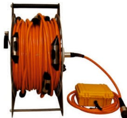
▲ Рис. 6. Скважинная гидрофонная 24-х канальная сейсмическая коса на катушке со скользящими контактами и батарейным блоком, обеспечивающим питание предварительных усилителей (производитель ООО «ГЕОДЕВАЙС»)
