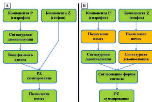
▲ Рис. 5. Сравнение «классического» графа обработки двухкомпонентных данных (А) и «адаптированного» графа с учетом специальной подготовки данных до PZ суммирования (Б).
