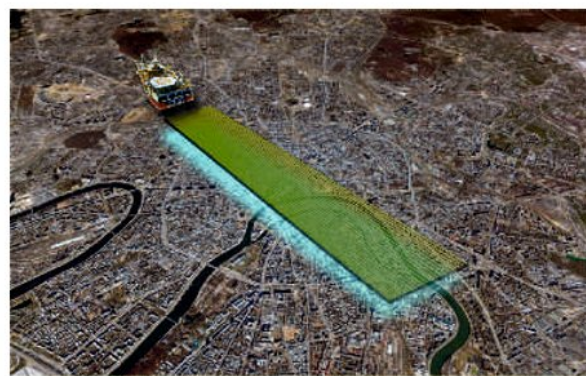
▲ Рис. 7. Сейсмическая 3D расстановка типового судна класса Ramform S (компания PGS) в развернутом состоянии в масштабе карты Москвы.
