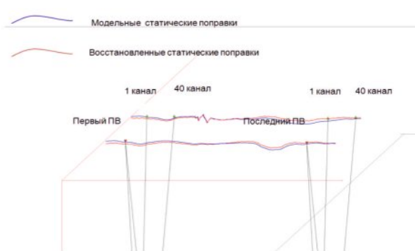
▲ Рис. 8. Модельные и восстановленные статические поправки, вычисленные в Фурье области.
