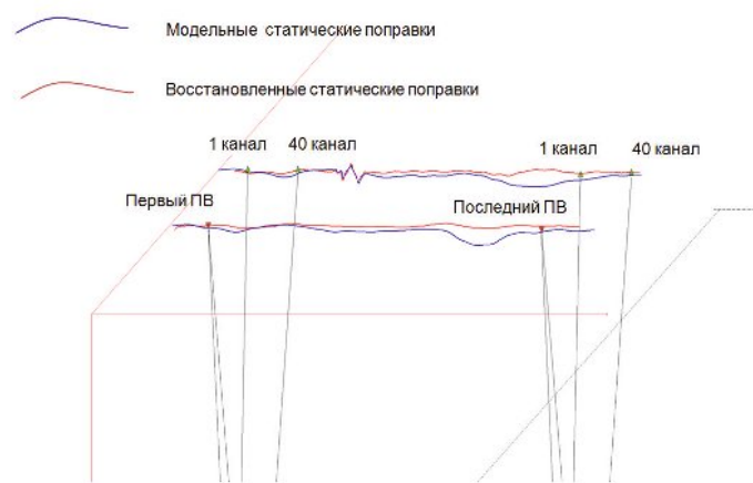
▲ Рис. 7. Модельные и восстановленные статические поправки, вычисленные стандартным методом (решением системы уравнений).
