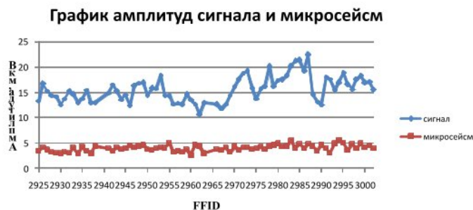
▲ Рис. 3. Графики амплитуд микросейсм и расчётных амплитуд целевых отражений в зависимости от номера файлов, полученные для условий лиманно-плавневой зоны, примыкающей к Темрюкскому заливу
