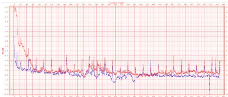
► Рис. 6. График значений уровня шумов до (синий) и после (красный) работы на профиле.
