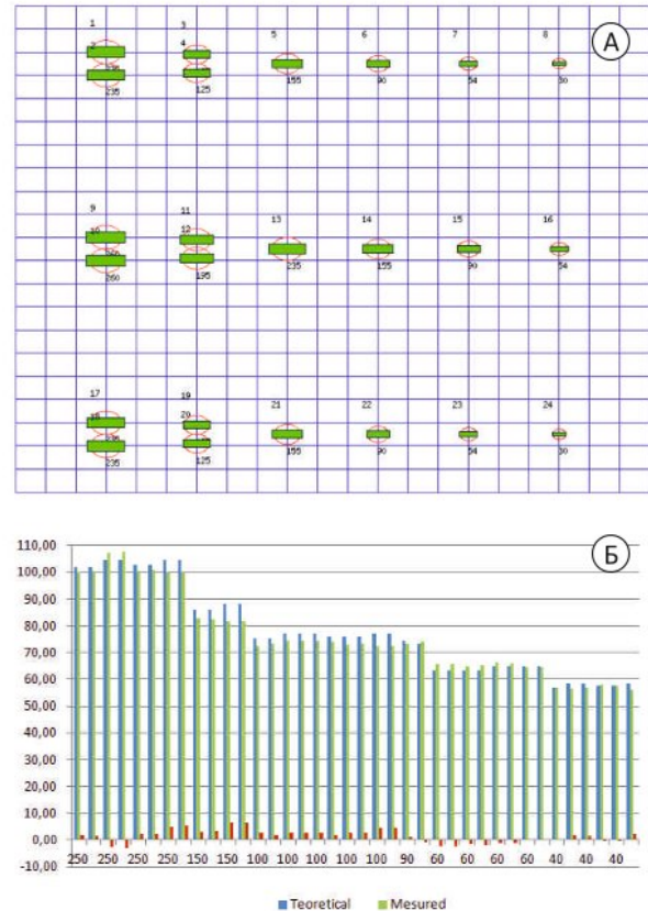
▲ Рис. 2. Пример схемы группового пневмоисточника (А) и диаграмма сравнения теоретического и фактического периодов пульсации (Б) каждой отдельной пневмопушки (синий – теоретический, зеленый – измеренный, красный – разница).
