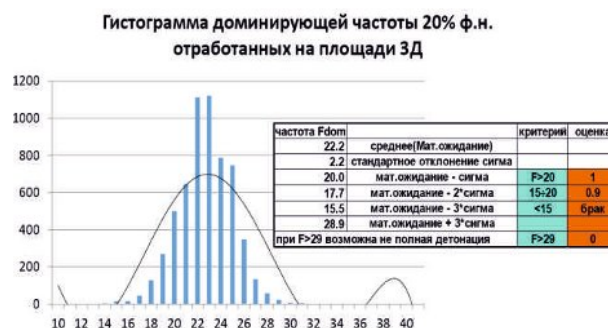
▲ Рис. 7. Гистограмма распределения доминантной частоты и уточненные критерии качества.
