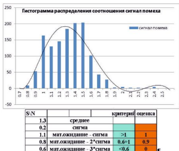
Рис. 13. Гистограмма распределения соотношения сигнал\помеха.
