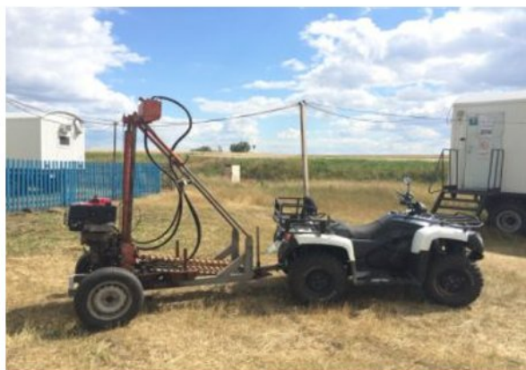
▲ Рис. 2. Малогабаритная буровая установка на квадроцикле.
