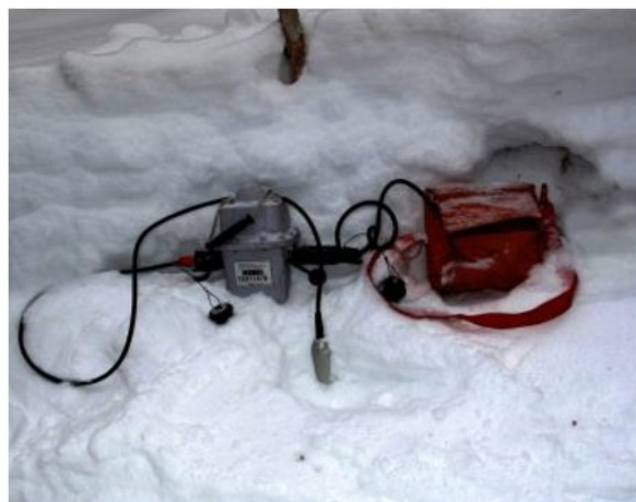
▲ Рис. 1. Бескабельный блок сбора и регистрации данных UNITE с внешним питанием.
