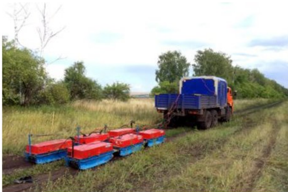
▲ Рис. 12. Импульсный источник «Геотон -15» в санном варианте на Камазе. Группирование 6-ти источников.
