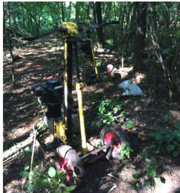
▲ Рис. 3. Малогабаритная буровая установка без транспортного средства.
