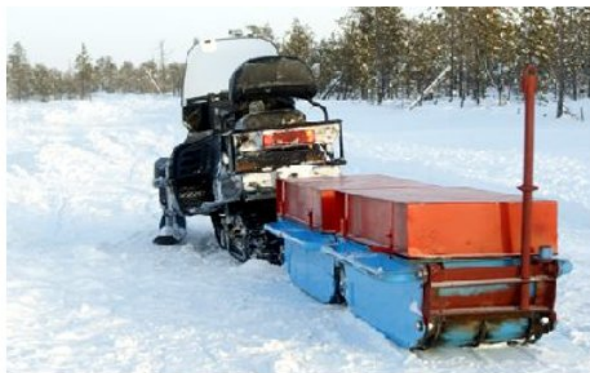
▲ Рис. 4. Источник «Геотон-15» на снегоходе.
