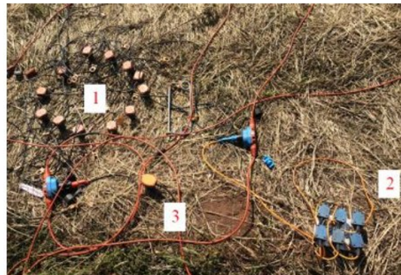
▲ Рис. 5. Установка сейсмических каналов на пикете приёма.
