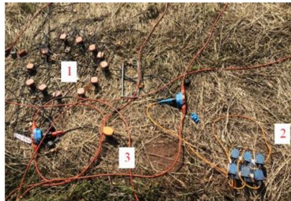
▲ Рис. 5. Установка сейсмических каналов на пикете приёма.
