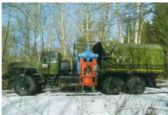
▲ Рис. 4. Гидропневматический источник сейсмических волн ГПИ-2
