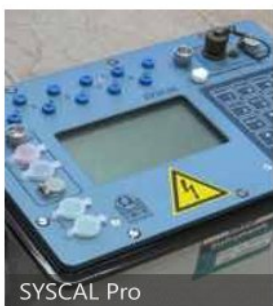
ИМВП: 8-канальный измеритель для ВП
