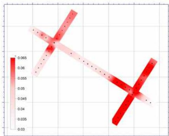
▲ Рис. 66. Поляризуемость третьего слоя, в данном случае отражающая суммарное влияние ВП на сигналы становления поля. Цветовая шкала приведена в долях единицы от 0,03 до 0,065.
