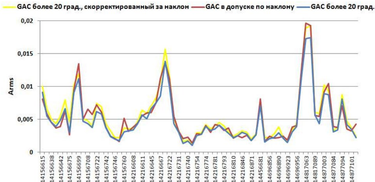
▲ Рис. 13. Графики распределения по ПП Armsc учетом поправочного коэффициента - 1/\cos(\text{rad}) для ПП с углом наклона датчика >20 (желтый цвет), в графики с \text{tilt} < 20^\circ поправки не вводились (красный цвет).
