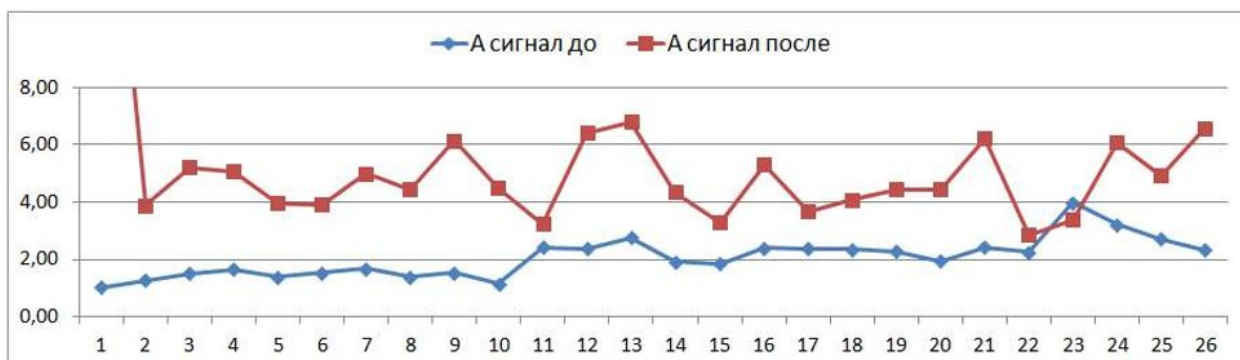
Рис. 5. Сравнение перебуров брака по А сигнала с разным весом заряда.
