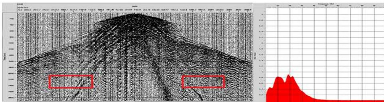
▲ Рис. 6. Сейсмограмма принята. S/N в допуске. Ненормированная АЧХ в окнах анализа сигнала.
