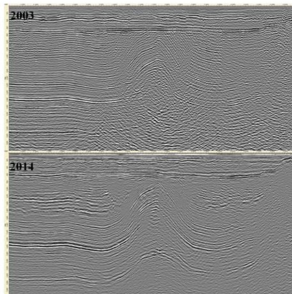
▲ Рис. 2. Сравнение результатов обработки (2003 г.) и переобработки (2014 г.) сейсмических данных 2D.
