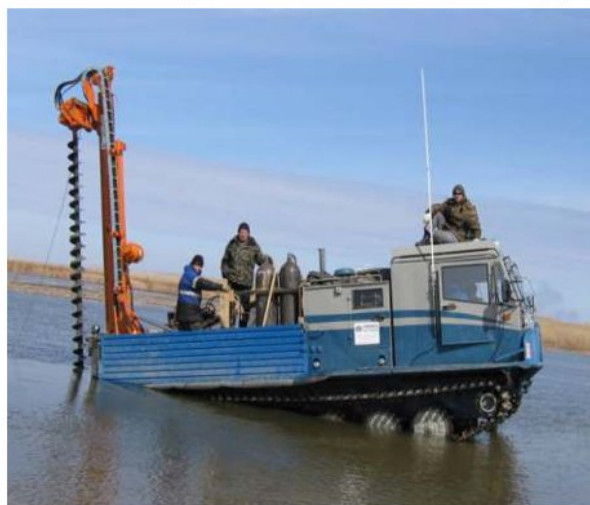
▲ Рис. 1. Скважинный источник на базе вездехода ТМ-130.
