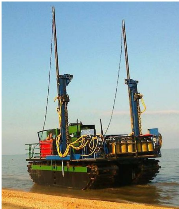
▲ Рис. 3. Внешний вид «взрыв-пункта», смонтированного на универсальной гусеничной платформе-амфибии.
