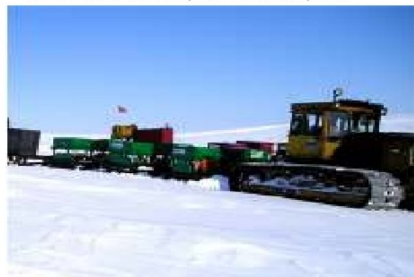
▼ Рис. 3. Отряд сейсмоисточников Геотон-30 на льду Тазовской Губы.
