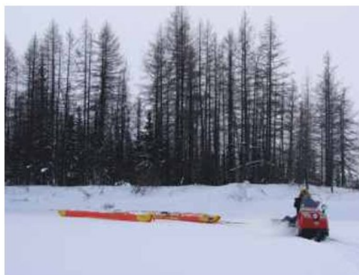
▲ Рис. 3. Транспортировка генераторно-измерительной установки ЭМС с помощью гусеничного вездехода и снегохода «Буран».
