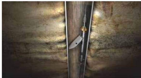
▲ Рис. 3. Трёхкомпонентный модуль зонда MaxiWave в скважине.
