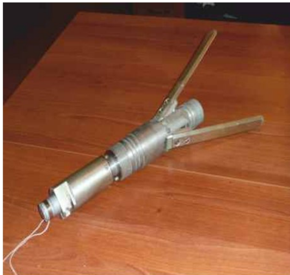
▲ Рис. 3. Прижимной блок скважинного сейсмического прибора с двумя управляемыми электромеханическими прижимами, развернутыми под углом.
