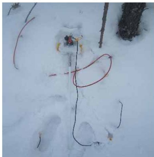
▲ Рис. 9. Модуль WRU с опрокинутой антенной
