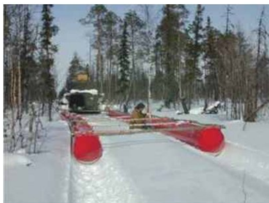
▲ Рис. 3. Транспортировка генераторно-измерительной установки ЭМС с помощью гусеничного вездехода и снегохода «Буран».
