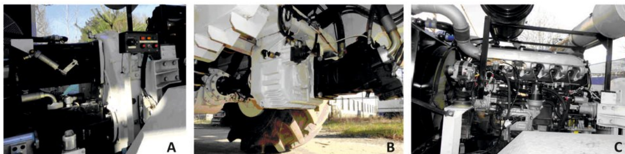
▲ Рис. 3. Серийно выпускаемый раздаточный редуктор АМ-365В фирмы HANSA-TMP (А), коробка передач С152.2 фирмы OMCI Transmission (Италия) (В) и двигатель ЯМЗ-650.10, (С) установленные на модернизированный виброисточник СВ-30/150БМ «Русич».
