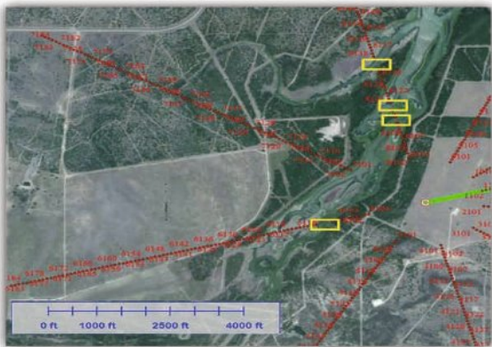
▲ Рис. 7. Карта расстановки сейсμοприемников в виде звезды с использованием бескабельного оборудования. Желтым цветом выделены препятствия, которые бы повлияли на оптимальную компоновочную схему при использовании кабельной системы.
