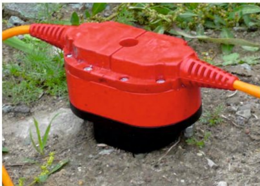
▲ Рис.13. Полевой модуль сейсмостанции SGD-SET
