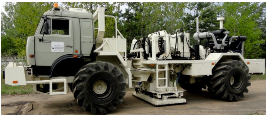
◀ Рис. 1. Модернизированная отечественная модель электрогидравлического вибрационного источника сейсмических сигналов СВ-30/150БМ «Русич».
