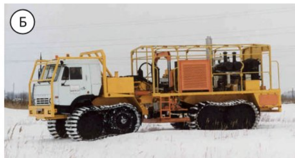
▲ Рис. 12. Универсальный вибросейсмический излучатель СВ-27/150БКГ: а – вариант перемещения по твёрдому грунту и дорогам; б - вариант передвижения по болотистой местности, зыбучим пескам, или по глубокому снегу
