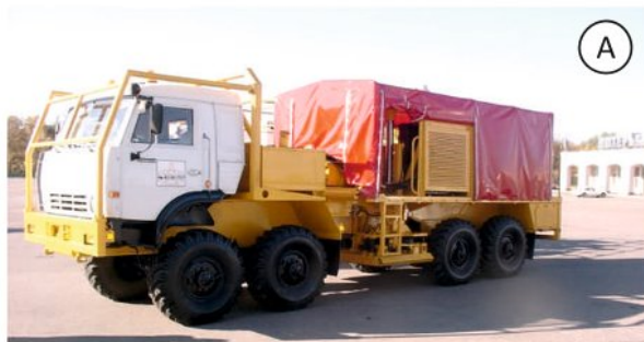
▲ Рис. 12. Универсальный вибросейсмический излучатель СВ-27/150БКГ: а – вариант перемещения по твёрдому грунту и дорогам; б - вариант передвижения по болотистой местности, зыбучим пескам, или по глубокому снегу
