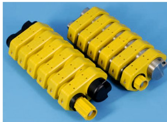
▲ Рис. 5. Донные регистраторы OBX в поликарбонатном и титановом исполнении.
