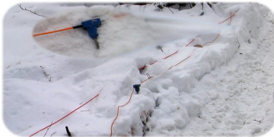
► Рис. 3. Типичные проблемы установки групп геофонов в поле
