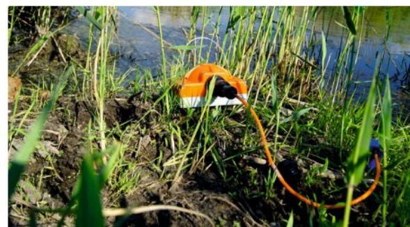
▲ Рис. 2. Бескабельный блок регистрации сейсмоданных на пункте приема.
