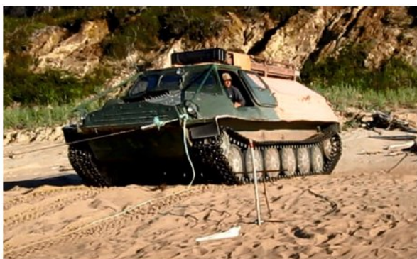
▲ Рис. 7. Подтягивание кабеля от раскладчика к вехе на пикете гусеничной техникой.
