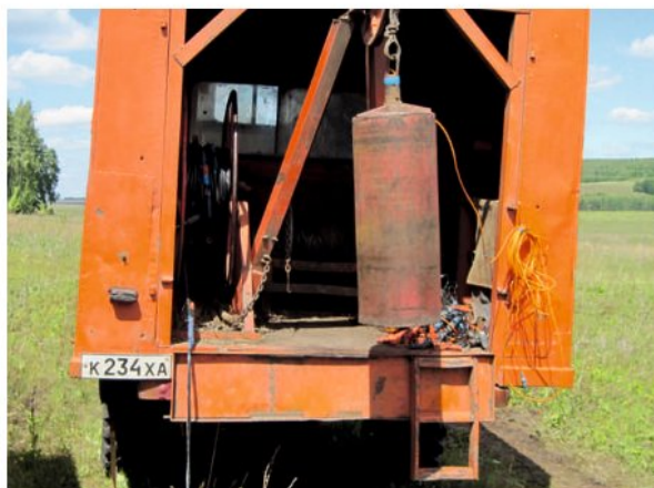
▲ Рис. 1. Источник «Падающий груз» на базе автомобиля ГАЗ-66
