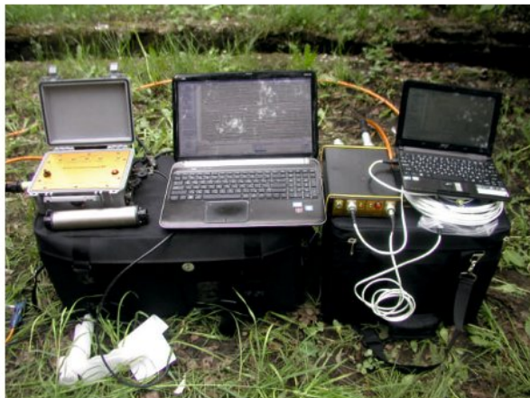
▲ Рис. 1. Блок синхронизации и блок регистрации телеметрической сейсмостанции "Лакколит-МТ" (слева), сейсмостанция "Лакколит-24-М3" (справа).
