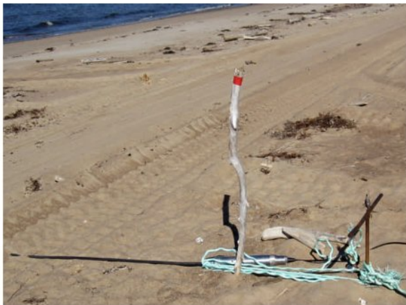
▲ Рис. 5. Приемная линия донного кабеля, модуль привязан к вехе и подключен к ЦСР
