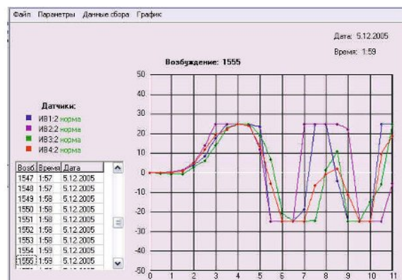
▲ Рис. 8. Графики ускорений массы излучателей по каждому источнику, передаваемые на экран компьютера, а также хранящиеся в памяти БСУ дешифратора.
