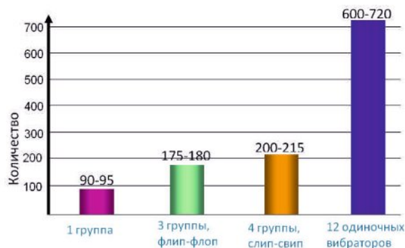
▲ Рис. 2. Сравнение производительности вибропартий с различным количеством вибраторов и при различных методиках наблюдений.
