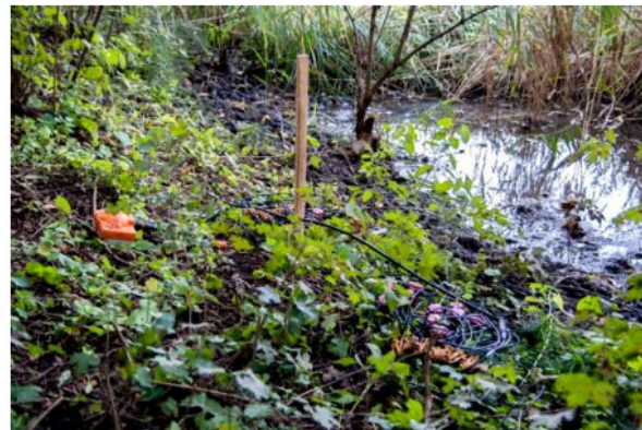
▲ Рис. 7 Расстановка групп сейсмоприемников и полевых блоков систем "Scout" и "SN 388" на заболоченном участке (группы сейсмоприемников установлены в точку)
