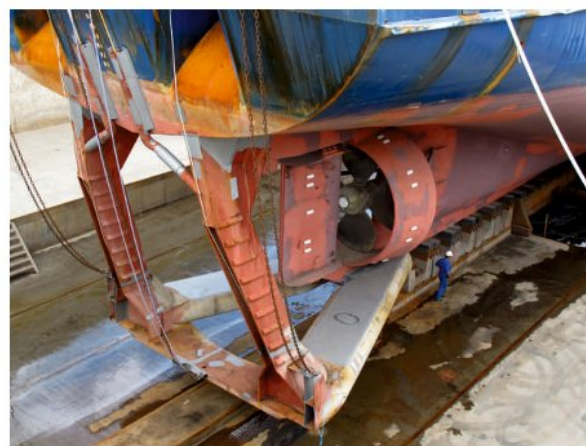
▲ Рис. 8. Система «skeg» для развертывания буксируемой косы подо льдом.
