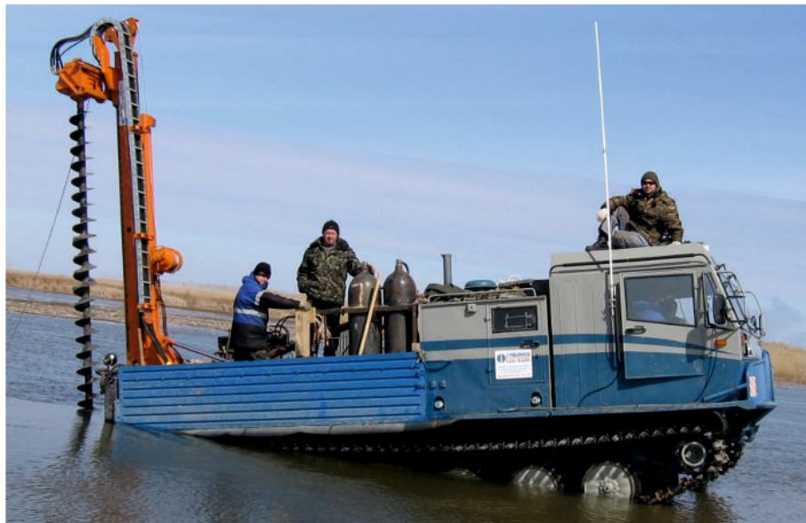
◀ Рис. 2. Взрыв-пункт с буровой шнековой установкой и погружным пневматическим источником ПИК-3 на базе плавающего гусеничного транспорта. Работы ГНЦ ФГУП «Южморгеология» на Северном Каспии [4].
