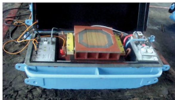
▲ Рис. 3. Сейсмоисточник «Геотон-12», ООО «Геосейс» г. Москва.
