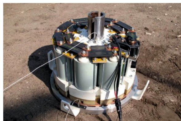
▲ Рис. 6. Сейсмоисточник «Волгарь-27» без внешнего кожуха.
