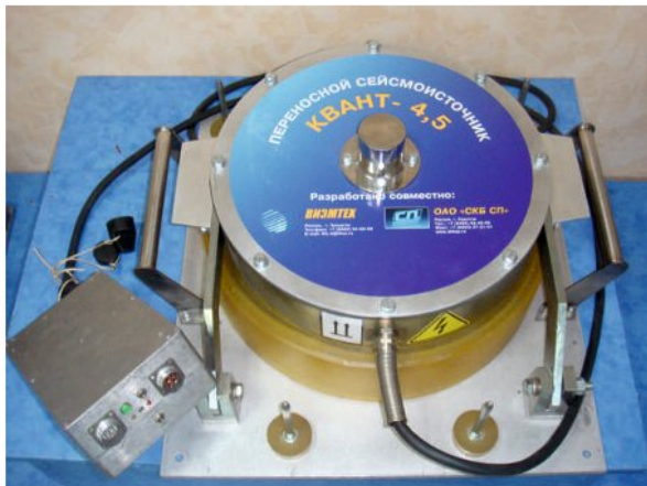
▲ Рис. 5. Переносной сейсмоисточник «КВАНТ-4,5»
