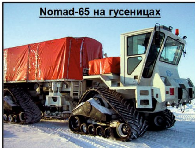
▲ Рис.1. Модификации тяжёлого вибратора Nomad-65. Его конструкция позволяет расширить диапазон частот как в сторону низких, так и высоких частот.
