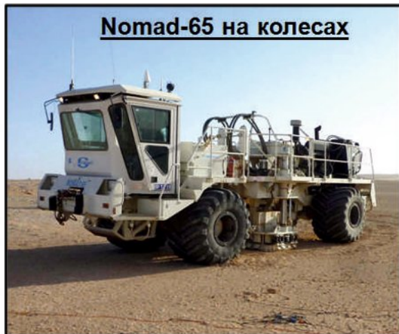
▲ Рис.1. Модификации тяжёлого вибратора Nomad-65. Его конструкция позволяет расширить диапазон частот как в сторону низких, так и высоких частот.
