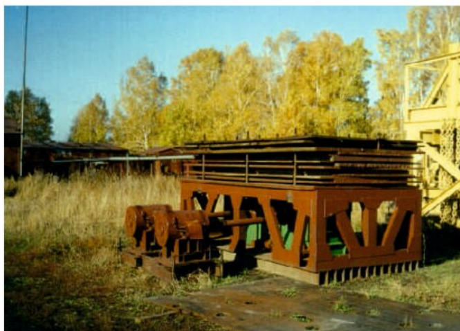
▲ Рис. 2.3. Передвижной 40-тонный вибратор дебалансного типа ЦВП-40.
