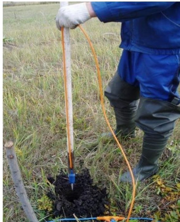
▲ Рис. 2. Заглубление приемного датчика
