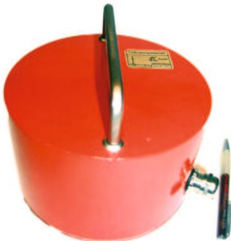
Рис.1. Внешний вид сейсмоприёмника СПВ-3к. ▲
