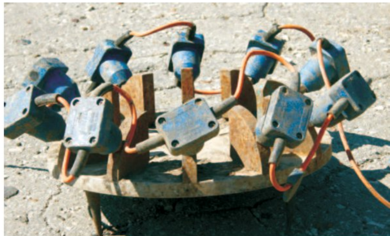
▲ Рис. 1. Внешний вид сейсмоприемного устройства азимутальной многокомпонентной установки сейсмоприемников АМУС (вид сбоку)
