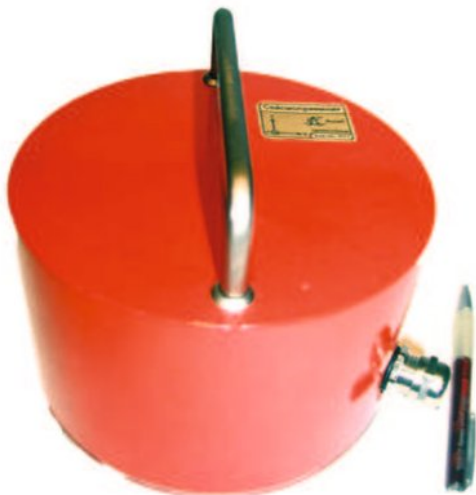
Рис.1. Внешний вид сейсмоприёмника СПВ-3к. ▲
